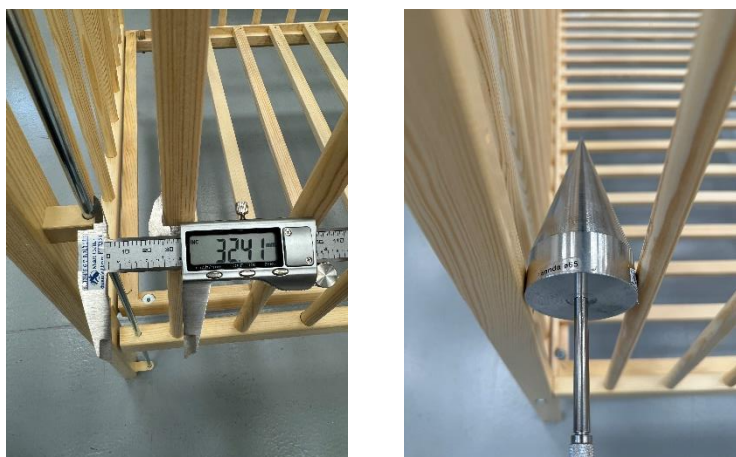
Obrázok č. 4 – Skúšanie dier, medzier a otvorov na vnútornej strane postielky
