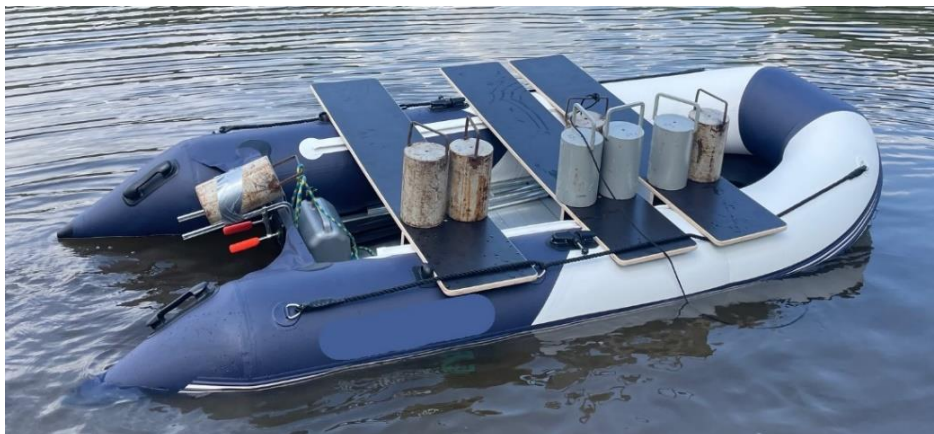
Obrázok č. 5 – Skúška statickej stability nafukovacieho člna
