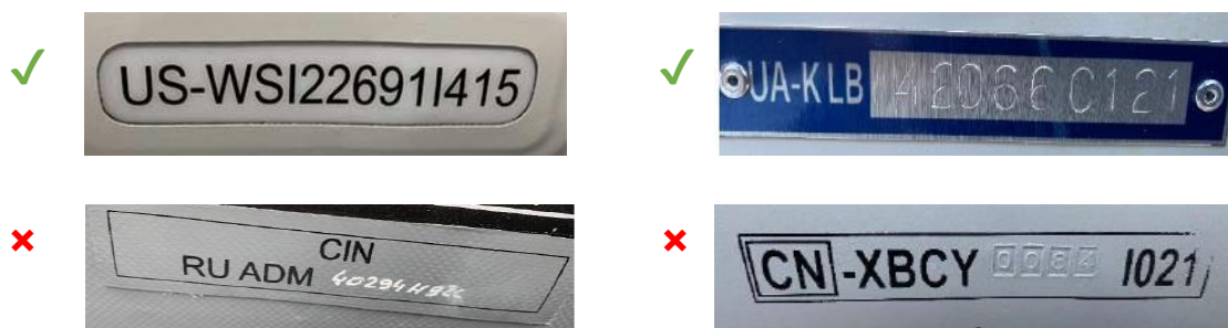
Obrázok č. 4 – Príklady správneho a nesprávneho identifikačného čísla plavidla
