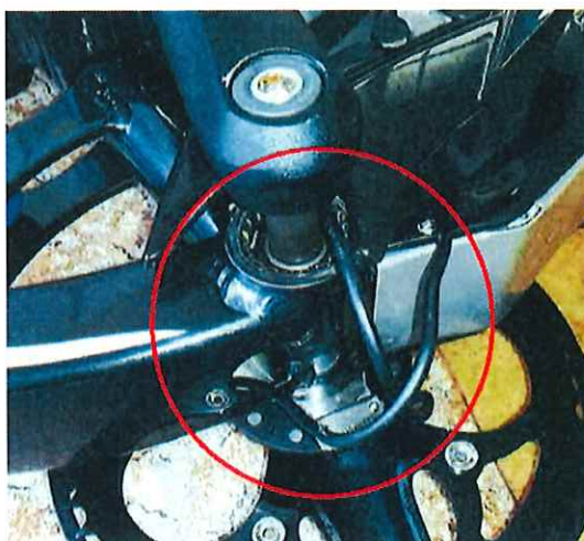
Obrázok č. 2 – Nedostatočná elektroinštalácia (EPAC bicykel)
