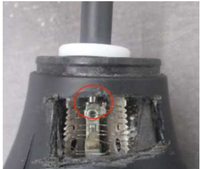
Obrázok č. 1 – Viditeľný prístup k živým častiam cez mriežku (kryt)
