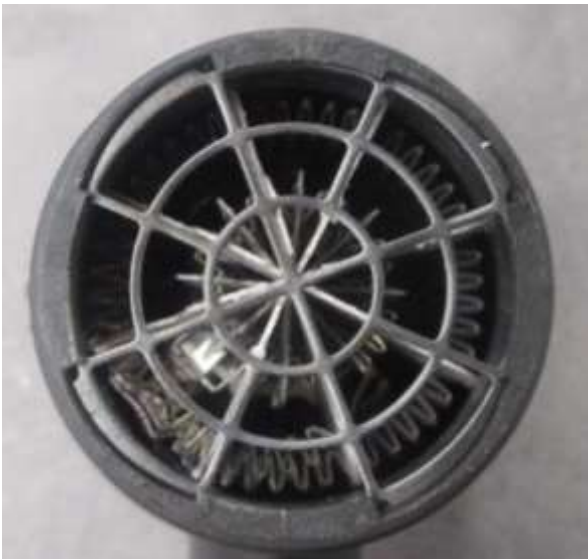
Obrázok č. 1 – Viditeľný prístup k živým častiam cez mriežku (kryt)
